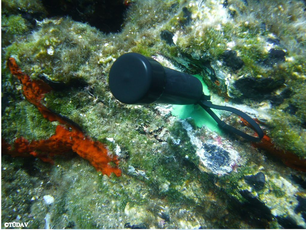
Şekil 10. Deniz suyu sıcaklığı izleme çalışmaları kapsamında sualtına yerleştirilmiş data-logger (TÜDAV)
